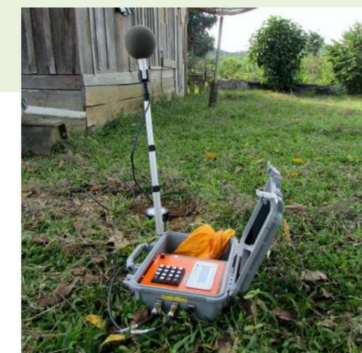
Medição de vibração utilizando o sismógrafo
