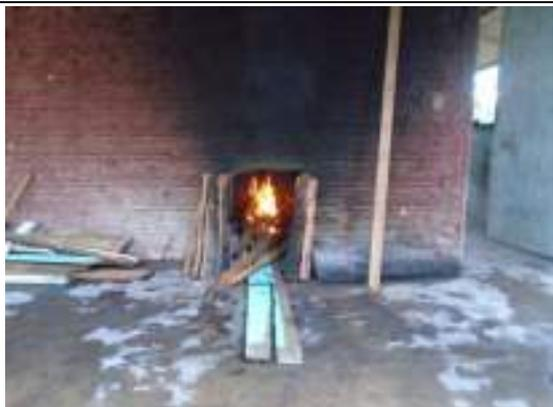
**Foto 101:** Lenha queimando para torrar farinha, processo que dura aproximadamente 40 minutos no forno (Casa de Farinha da Aldeia Paquiçamba, 02/5/19).
