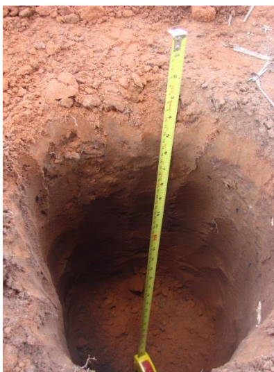
Figura 60. Sítio Ribeirão Grande – Sondagem (boca-de-lobo) evidenciando sedimentos arenosos com nódulos de laterita (sedimentos exógenos)
