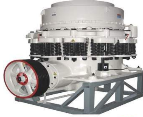
FIGURA17 MODELO DE UM BRITADOR CÔNICO.
