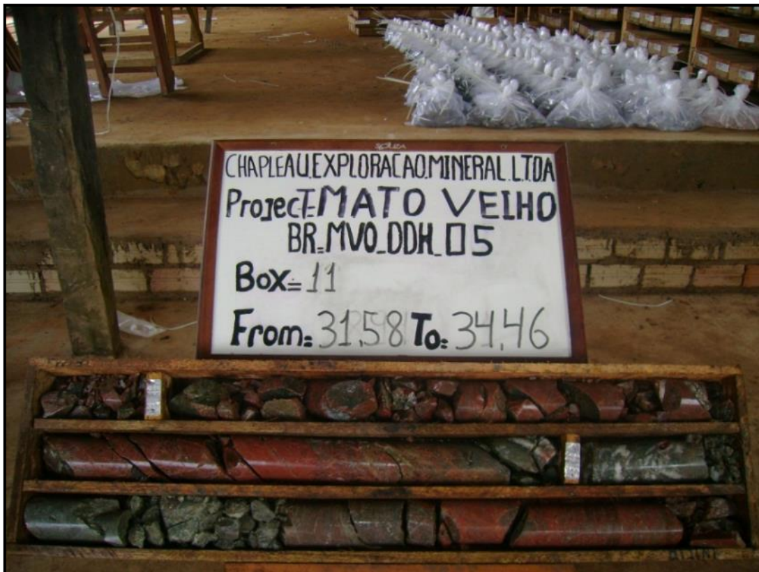
Figura 4.1-17 - Alteração da vulcânica cisalhada encaixante, com sericita+clorita+hematita, lateral ao veio cinza brechóide com pirita.
