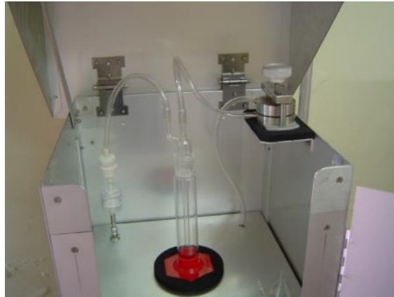
Figura 4.1-94 - Sistema de porta-filtro seguido por borbulhador aplicado à determinação de FMC e SO 2 .
