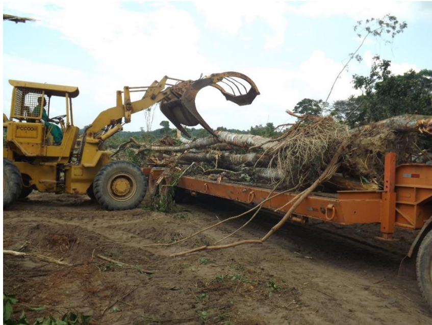
Figura 7.2-3 - Trator florestal arrastador (Skidder) e transporte primário (Fonte: Terra Meio Ambiente).
