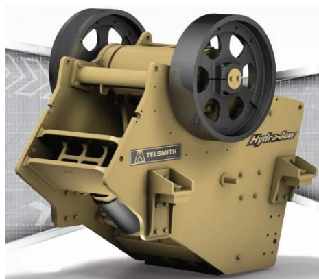
FIGURA 16 MODELO DE UM BRITADOR DE MANDÍBULA.
