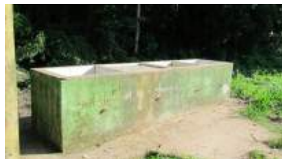
Foto 36: Tanques para deixar mandioca de molho existentes na Casa de Farinha da aldeia Guary-Duan.
